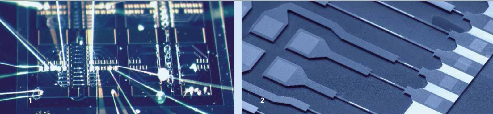
1 Hochfrequenz-MEMS-Komponenten aus Nanodiamant, hergestellt auf einem 3"-Silizium-Wafer.
